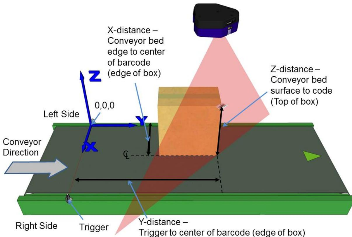
Figure 46: Top-read 3<sup>rd</sup> barcode placement
