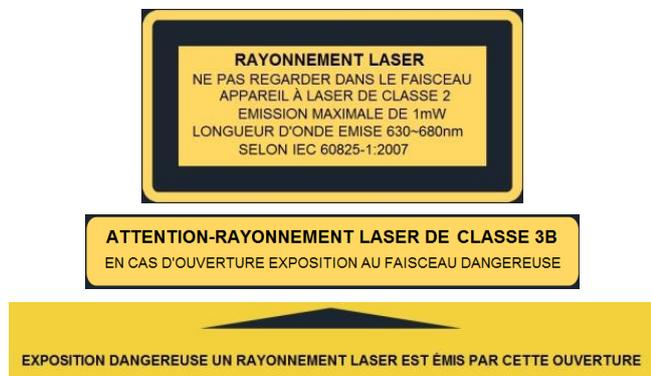
Figure 2: Exemple d'étiquettes d'avertissement laser
